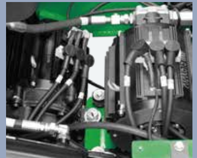
Traction et levée adoptent des moteurs synchrones à aimants permanents grâce au contrôleur Enpower.
