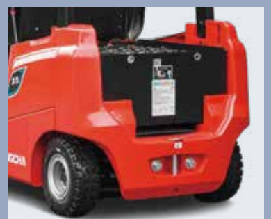
La batterie est placée à l'arrière du chariot
