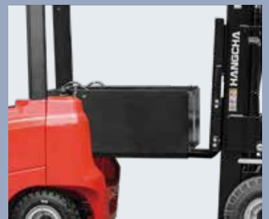
La batterie peut être retirée par l'arrière pour son remplacement (uniquement sur la version batterie au plomb)
